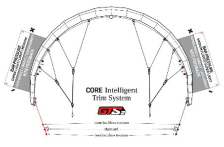
El "CORE Intelligent Trim System" (CIT) permite al rider ajustar a su gusto la presión de la barra y la velocidad del giro.
