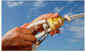
Kontrolliere vor jedem Start dein ROTOR-Quickrelease und deine Sensor Leash auf Funktionalität und Leichtgängigkeit! Führe vor jedem Start eine Testauslösung durch!
