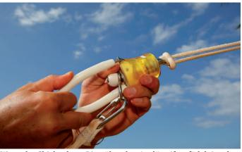
Wenn der Chickenloop-Ring über den Auslöestift gefädelt ist, den Chickenloop-Ring in das ROTOR-Quickrelease einlegen.
